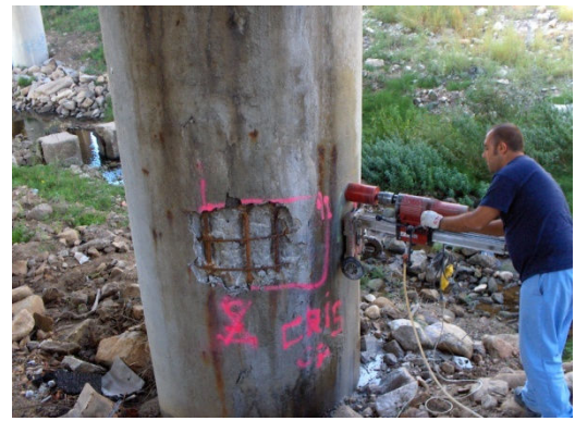
Figura 70: Extração de um carote num pilar.
