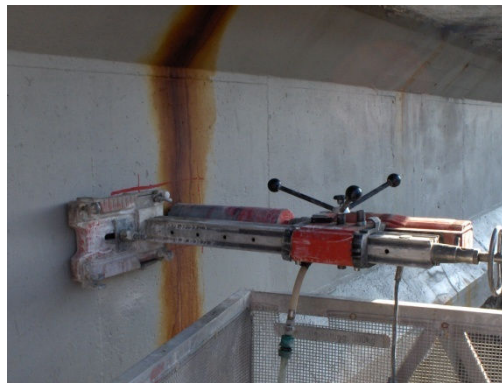
Figura 71: Extração de um carote numa viga.
