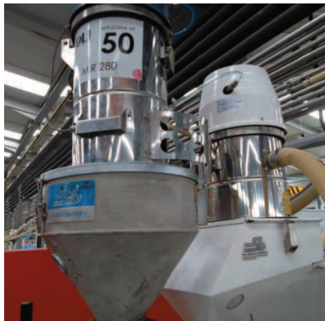
Figura 25 - Tremonhas de matéria-prima (esquerda) e pigmento (direita)
