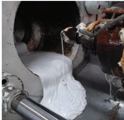
Figura 29 - Purga da matéria-prima na máquina 50
