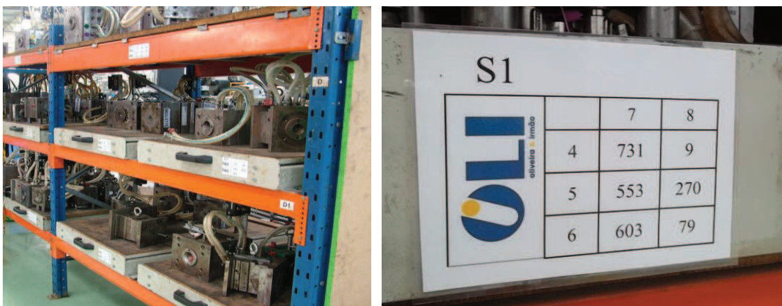
Figura 45 - 5'S – Estantes dos moldes - depois
