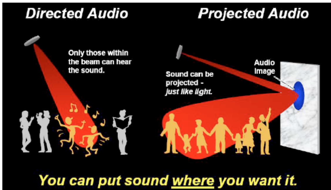
Figura 6 - Esquema que ilustra a diferença entre o som direcional direto e projetado.
