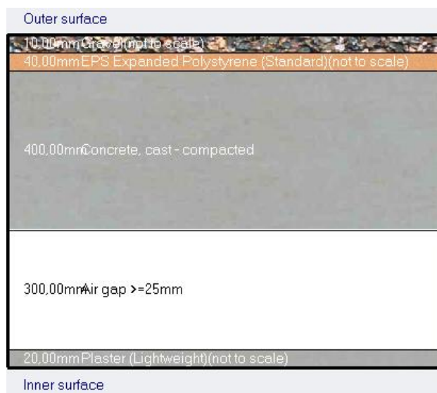
Figura 29 - Materiais usados na cobertura do edifício, como visto no DesignBuilder . De fora para dentro: gravilha, isolamento EPS, betão armado e reboco na parte mais interior.
