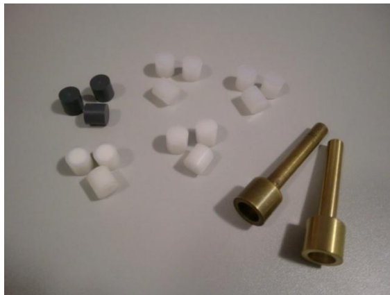
Figura 3.2 – Imagem da geometria dos pinos e dos adaptadores.
