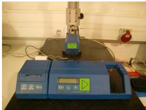
Figura 3.5 – Rugosímetro Hommel Tester T1000 utilizado na medição da rugosidade dos discos e das amostras.
