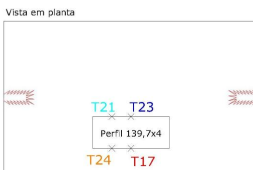
Figura 5.13 – Ensaio 1, localização do perfil no forno e dos respectivos termopares
