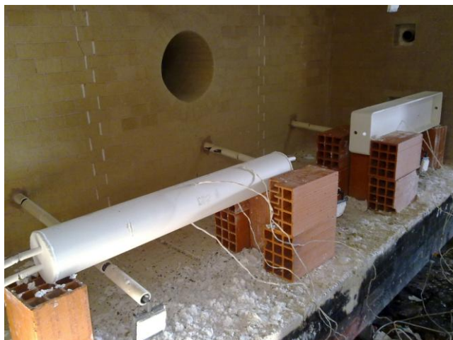
Figura 5.25 - Ensaio 3, disposição dos perfis no forno
