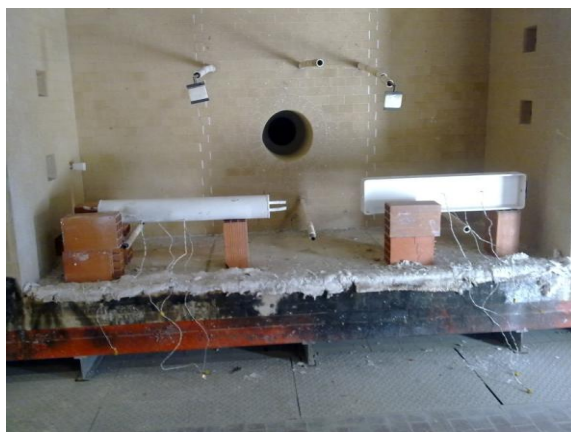
Figura 5.46 - Colocação dos perfis no forno, ensaio 6
