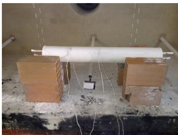
Figura 5.12 - Foto do ensaio N°1 com perfil CHS 139,7x4
