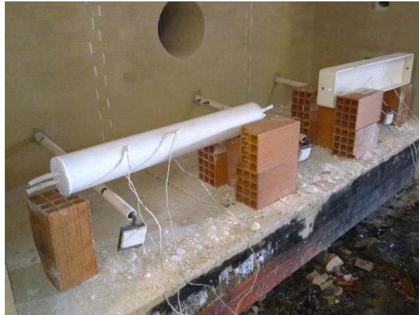
Figura 5.16 – Ensaio 2, disposição dos perfis no forno
