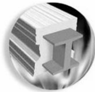
Figura 3.1 - Expansão ao fogo de tinta intumescente
