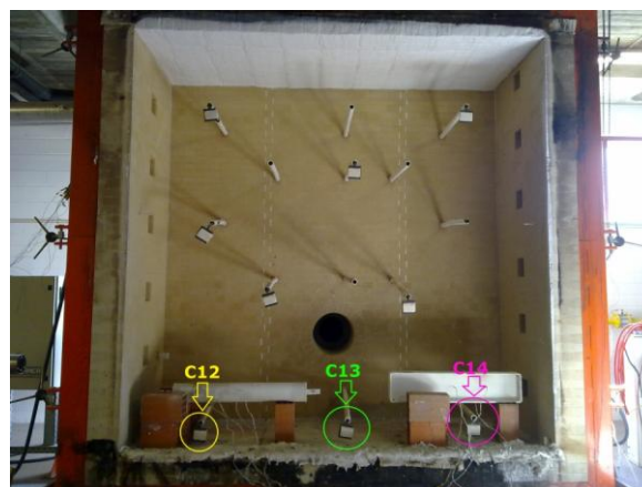
Figura 5.11 – Localização dos termopares de controlo no forno
