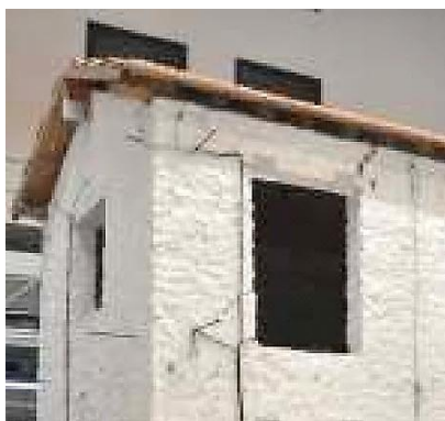
Figura 38: Visualização da localização de alguns transdutores (LVDT's). Fonte: [75].
