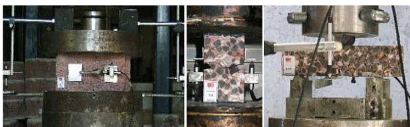
Figura 12: Ensaios de compressão, de tração direta e por flexão em blocos. Fonte: [71].
