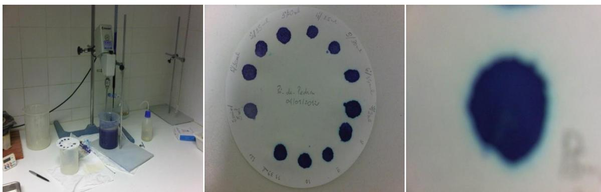
**Fig.16** – Ensaio de determinação do valor de azul-de-metileno (VBS) com respetiva apresentação da mancha de suspensão em papel de filtro com a presença de auréola azul, indicadora da presença de azul-de-metileno em excesso
