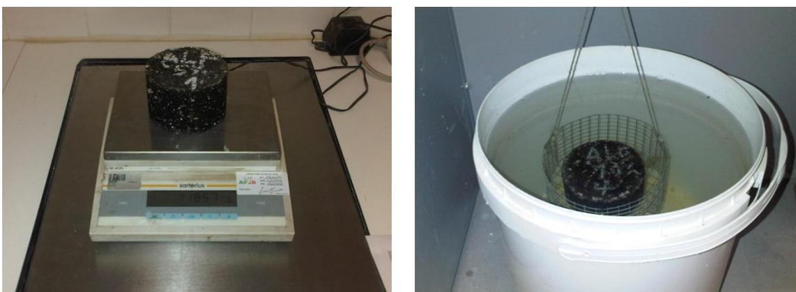
**Fig.24** – Pesagem dos provetes secos e imersos em água com recurso a cesto de rede
