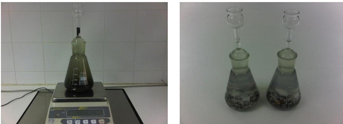
Fig.17 – Determinação da massa volúmica pelo método do picnómetro
