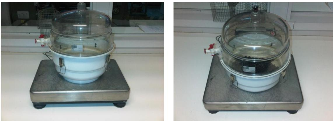
**Fig.27** – Determinação da baridade máxima teórica através do método do picnómetro de vácuo
