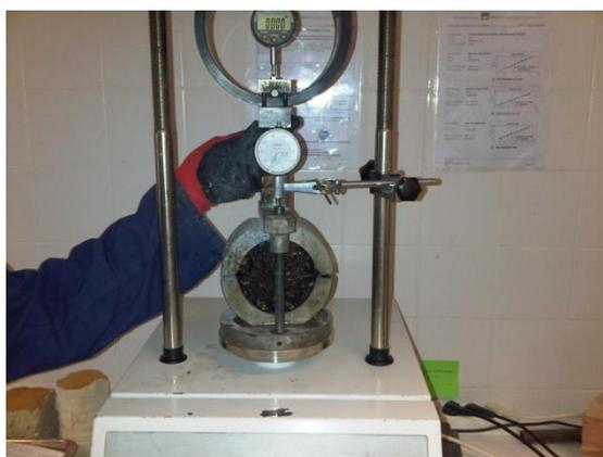
**Fig.26** – Equipamento utilizado no ensaio de compressão Marshall
