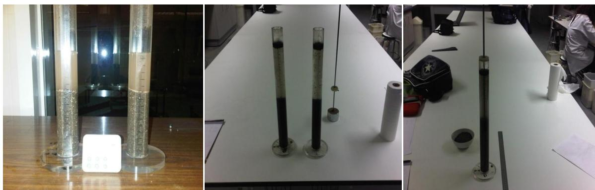
**Fig.14** – Ensaio de determinação do teor equivalente de areia (EA)
