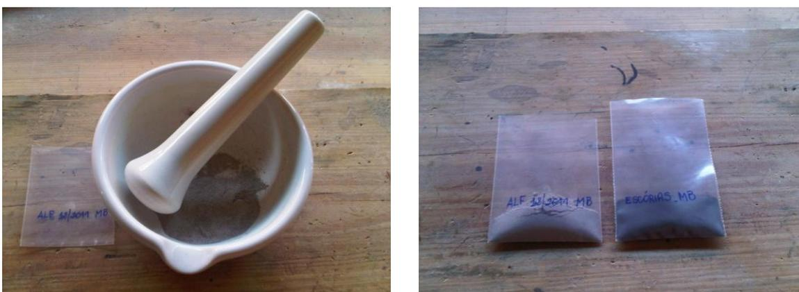
Fig.18 – Obtenção das amostras de resíduos para determinação de fases cristalinas
