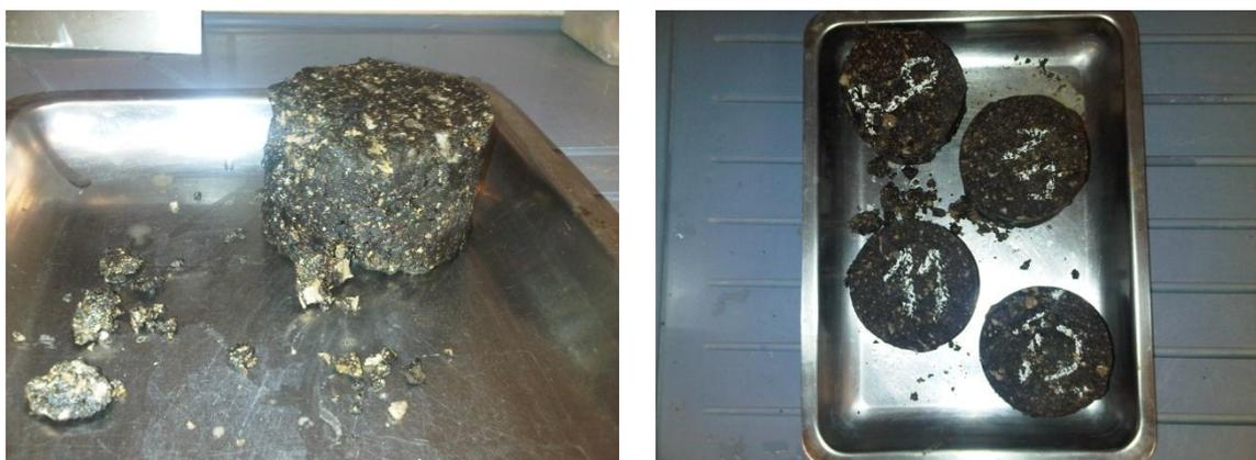
**Fig.57** – Desagregação de provetes de MB Fuso A com incorporação de 5% LCC
