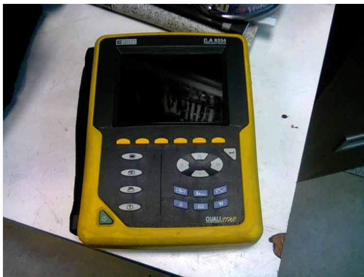
Figura 7.23: Sistema portátil QualiStar ® ( Chauvin-Arnoux , França) para medições em tempo real em máquinas elétricas (Lab de Máquinas Elétricas, DEEC-FEUP)
