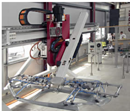
Figura 3.22: Exemplo de um sistema de transferência crossbar (estão visíveis as ventosas que suportam a peça) [11].
