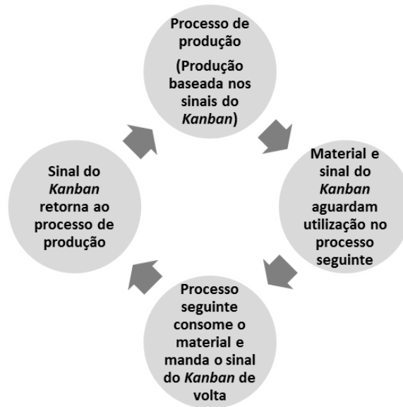
Figura II.4 – Ciclo do Kanban de Produção. (fonte: Adaptado, intranet Bosch)
