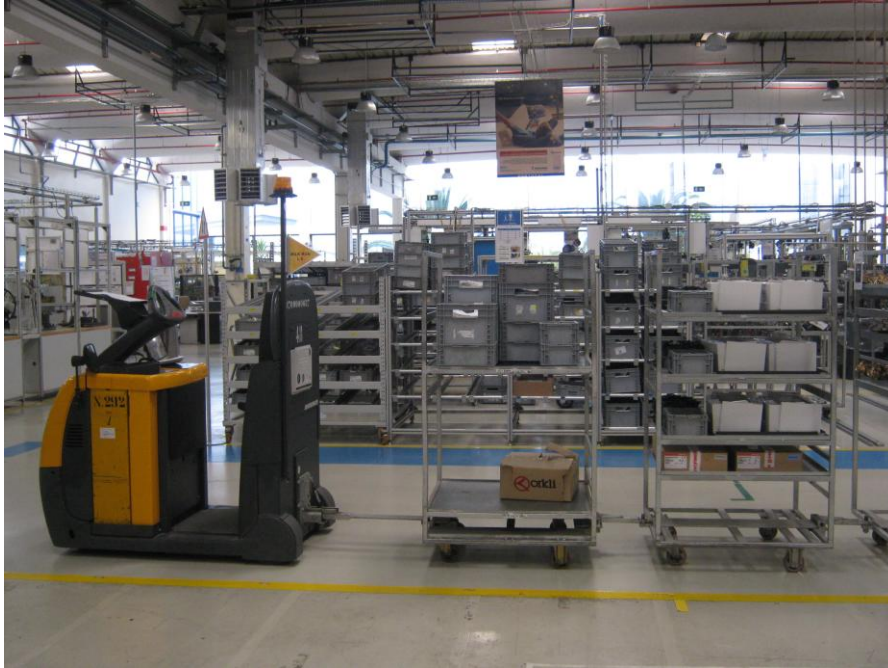
Figura II.6 – Exemplo de um comboio logístico.
