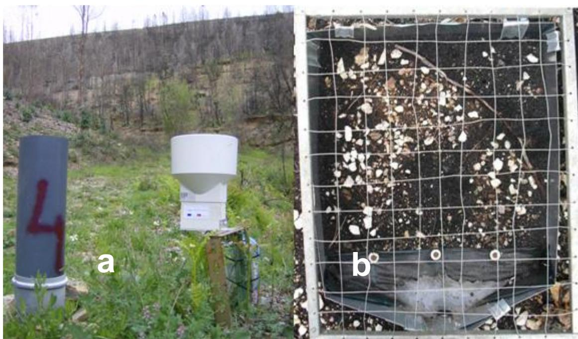
**Figura 4** – (a) Pluviómetro totalizador e automático, (b) Grelha de descrição do coberto numa microparcela.
