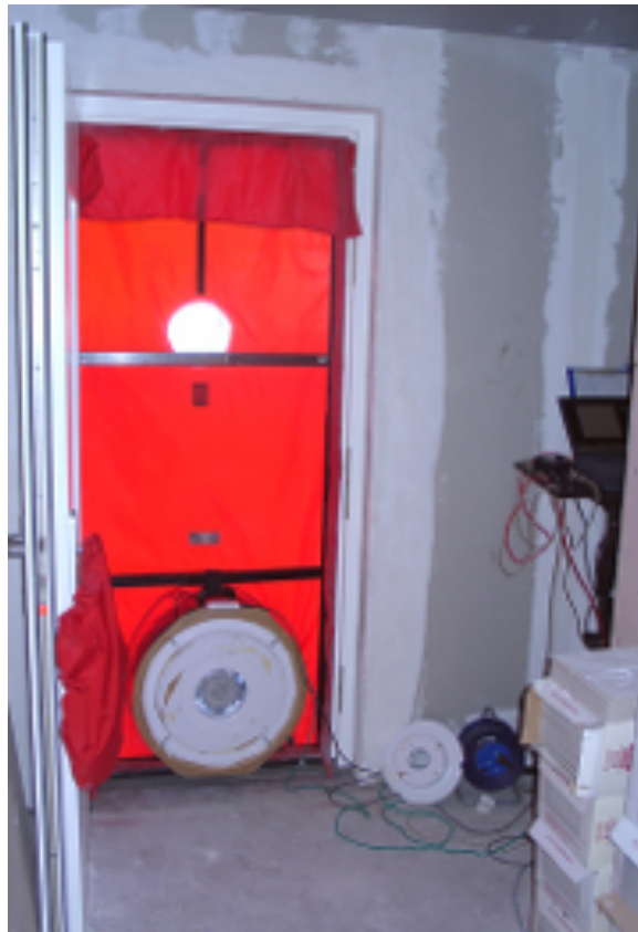
Figura 3.6– Blower door test (STEUDLE et al., 2005).
