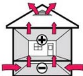
Figura 2.9 – Ventilação natural – efeito chaminé (VERSAGE, 2009).
