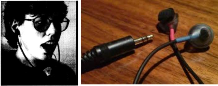
**Figura 4:** Microfones binaurais (adaptado de Ternström, 1993: 105).
