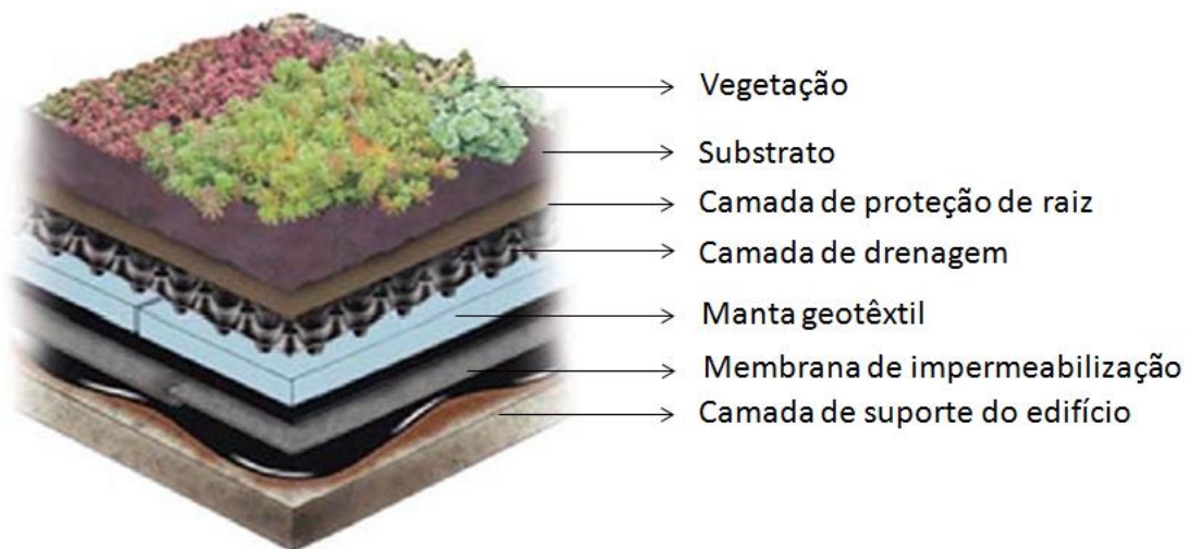
Figura 2.4 Diferentes camadas das coberturas verdes (Adaptado de Tolderlund, 2008)
