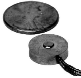
Figura 5.1: Células de carga miniatura de 5lbs usadas no robô humanóide.
