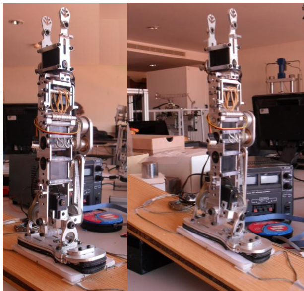
Figura 5.8: Testes efectuados numa superfície de inclinação variável com os quatro sensores de força colocados nas extremidades da placa de acrílico que por sua vez suporta uma perna.
