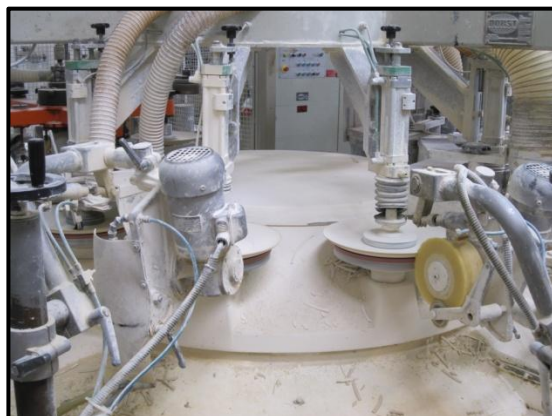
Figura 8 - Eliminação das rebarbas de bordo.
