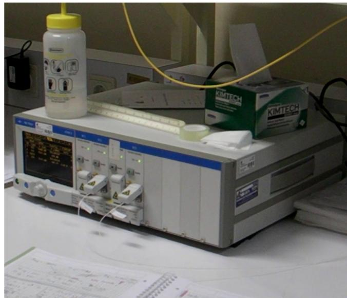
Figura 3.5: Foto do conjunto de lasers de comprimento de onda e potência sintonizável.
