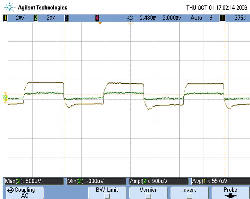
Figura A.7: Bomba e sinal sobrevivente sem controle, tal como visualizados no osciloscópio (Experiência 5).
