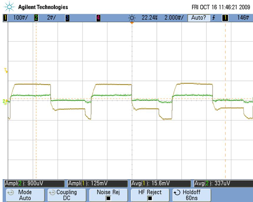
Figura A.26: Bomba e sinal sobrevivente sem controlo, tal como visualizados no osciloscópio (Experiência 13).
