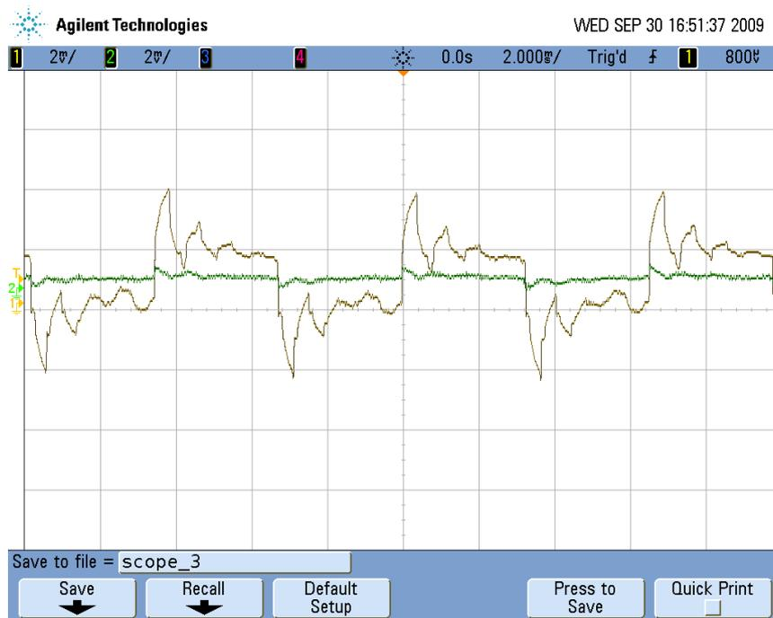
Figura A.5: Bomba e sinal sobrevivente com controlo, tal como visualizados no osciloscópio (Experiência 3).
