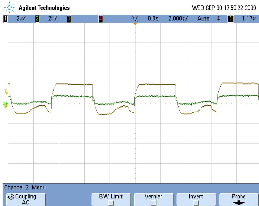
Figura A.29: Bomba e sinal sobrevivente sem controlo, tal como visualizados no osciloscópio (Experiência 4).
