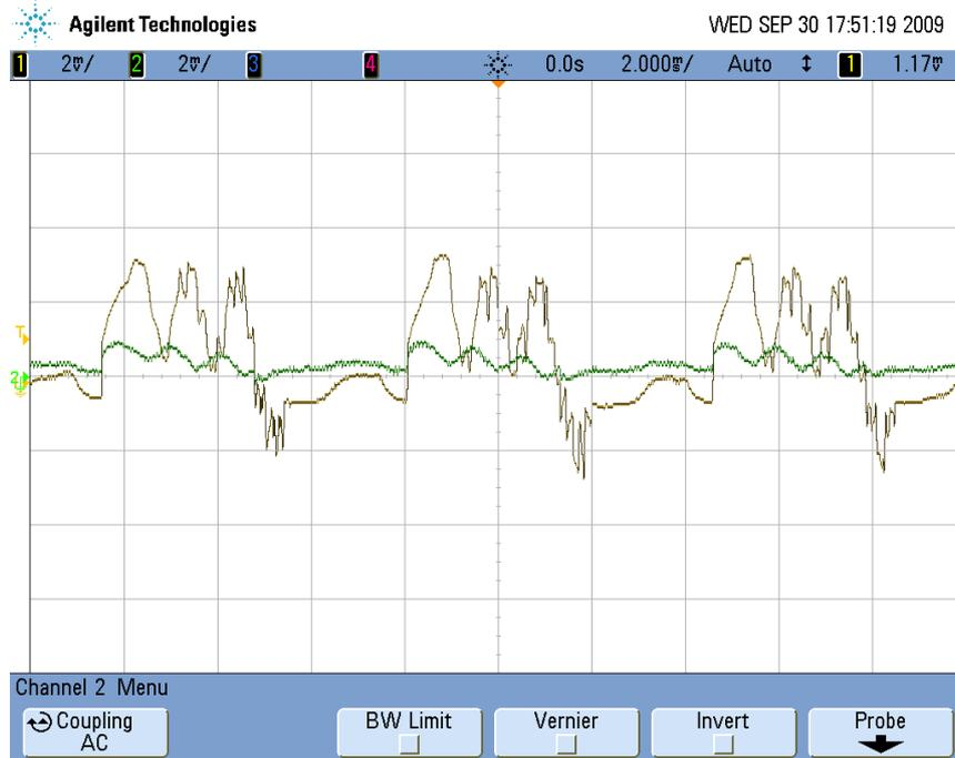
Figura A.30: Bomba e sinal sobrevivente com controle, tal como visualizados no osciloscópio (Experiência 4).
