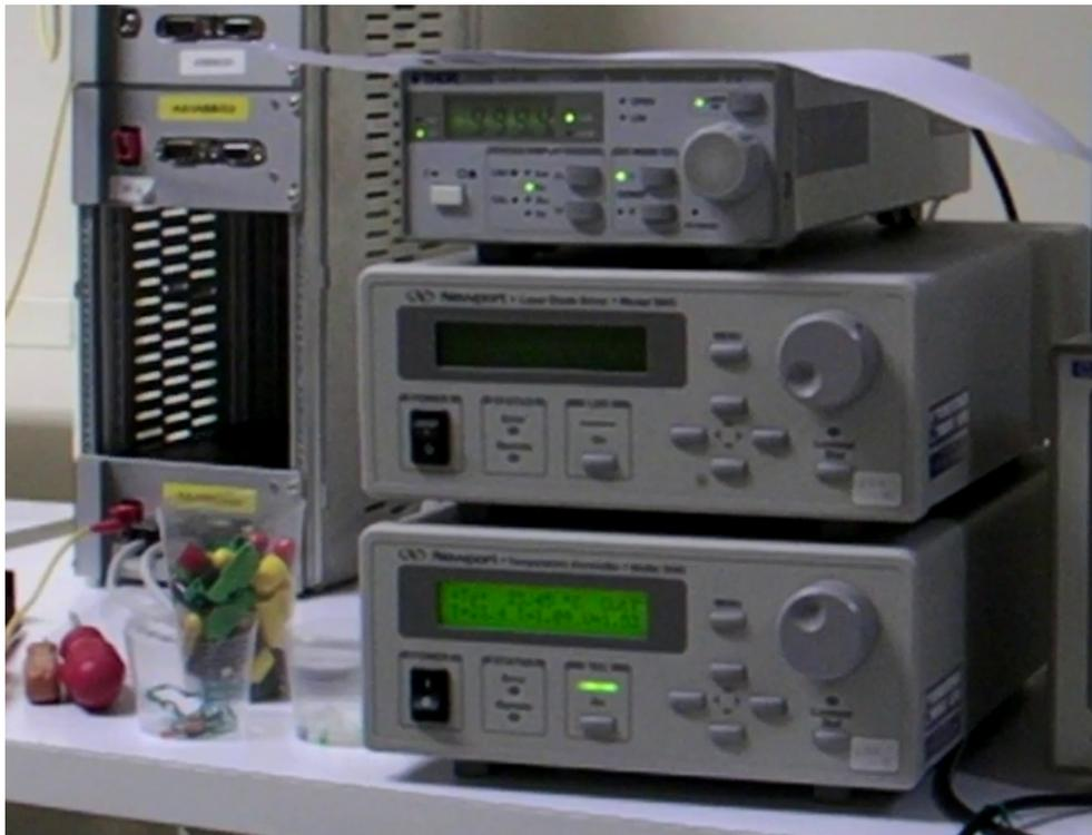
Figura 3.13: Foto da bomba, e respectivos TEC e *laser drivers* para seu controle.
