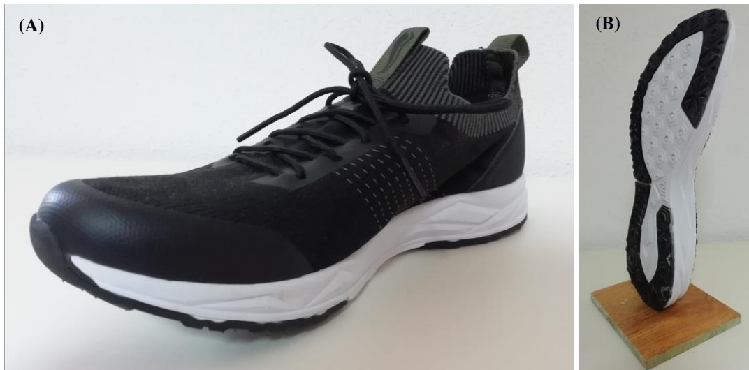
Figura 16. (A) Sapatilha desportiva escolhida, com uma sola exterior em TPR e uma entressola em Phylon (espuma de EVA aquecida e comprimida); (B) Sola preparada para aquisição de forma.
