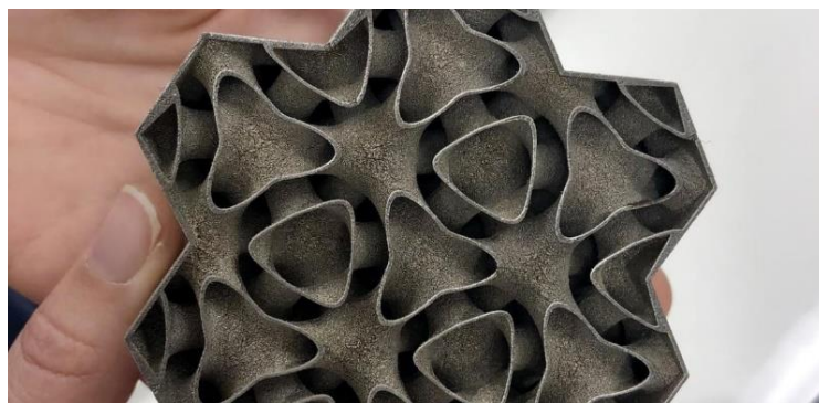
Figura 7. Estrutura de treliça do permutador de calor da GE [17].
