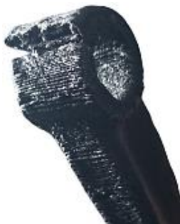
Figura 144 – Rotura total na região circular
