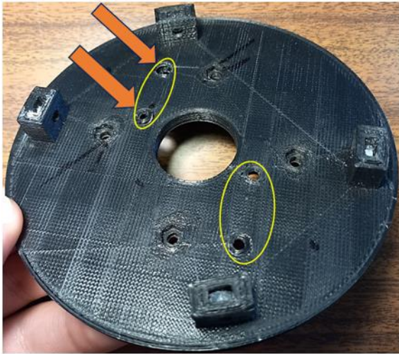
Figura 60 – Vista de topo da peça da base com deformações e rotura
