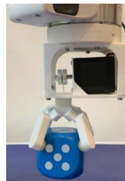
Figura 30 – Garra de quatro pinças feita por Liu et al. (2021)
