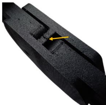
Figura 127 – Veio estrutural da carcaça com rotura total
