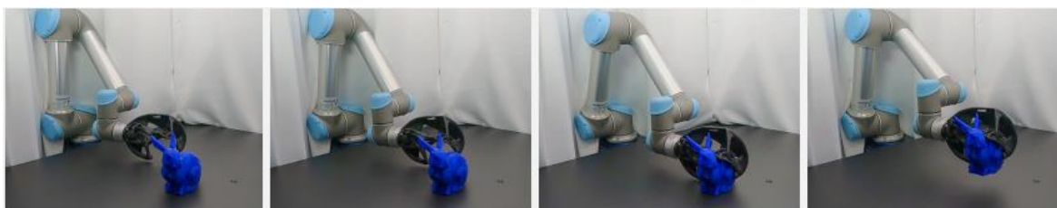
Figura 31 – Uma das garras passivas geradas no trabalho de Kodnongbua et al. (2022)
