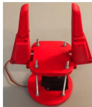
Figura 21 – Garra articulada de duas pinças produzida por Santos (2019)
