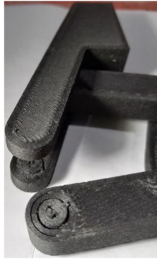
Figura 113 – Veio que entrou em rotura total da garra
