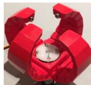
Figura 27 – Garra flexível de quatro pinças (Aidan, 2017)
