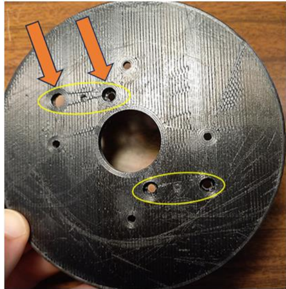
Figura 61 – Vista de trás da peça da base com deformações e rotura
