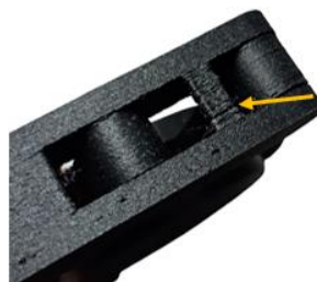
Figura 128 – Veio estrutural da pinça com rotura total
