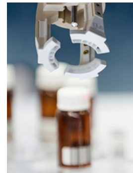
Figura 9 – Garra da Carecos Kosmetik com a colaboração da Igus (AMFG, 2020)
