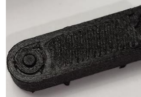
Figura 105 – Parte que se separou da restante peça
