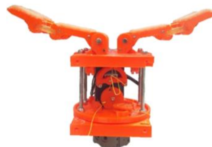
Figura 25 – Garra articulada de quatro pinças acionada por tendão (Gouveia & Advisor, 2017)
