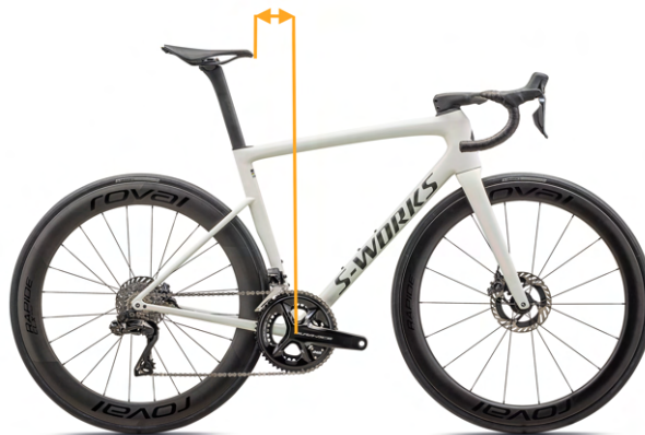
Figura 2.11: Medida do recuo do selim.
