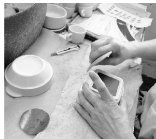
Fig. 4 Aplicação da película de prata (Fonte: Imagem da primeira autora).
