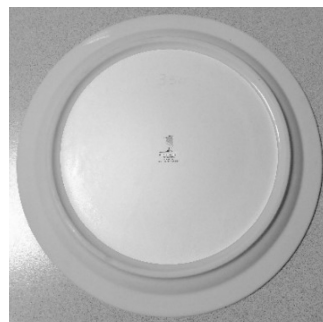
Fig. 5 Peça em porcelana com película de prata depois de cozida (Fonte: Imagem da primeira autora).
