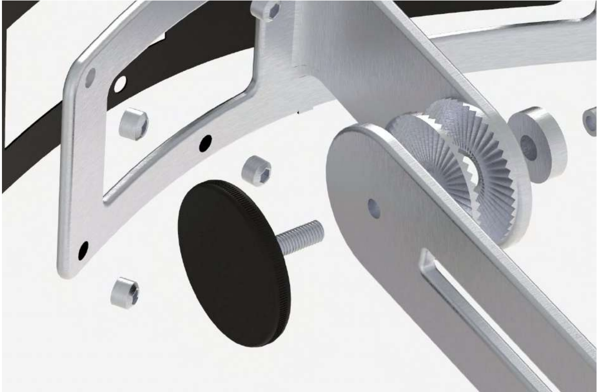
fig. 50 - Pormenor do manipulô de rotaç o.
