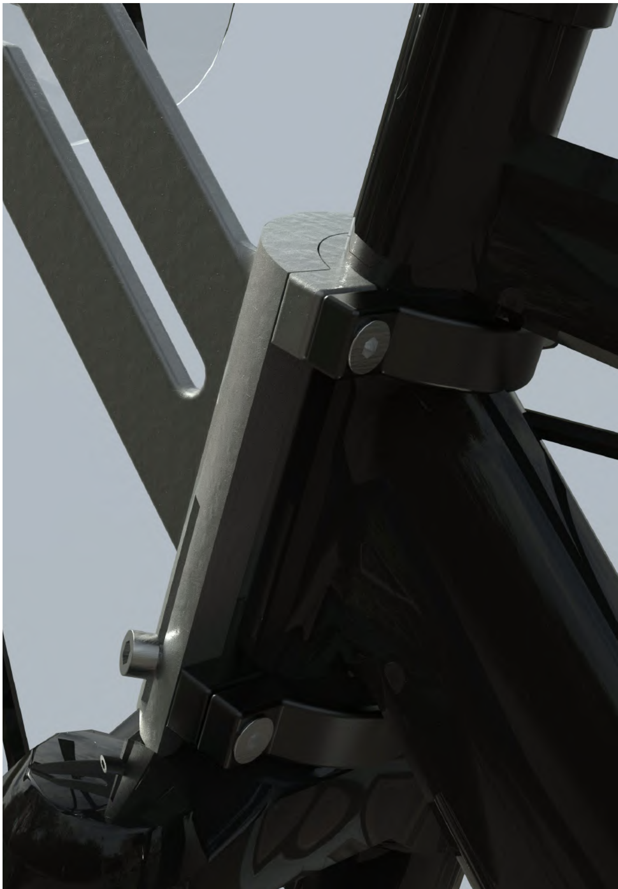
fig. 49 - Pormenor do elemnto de fixação à bicicleta.
