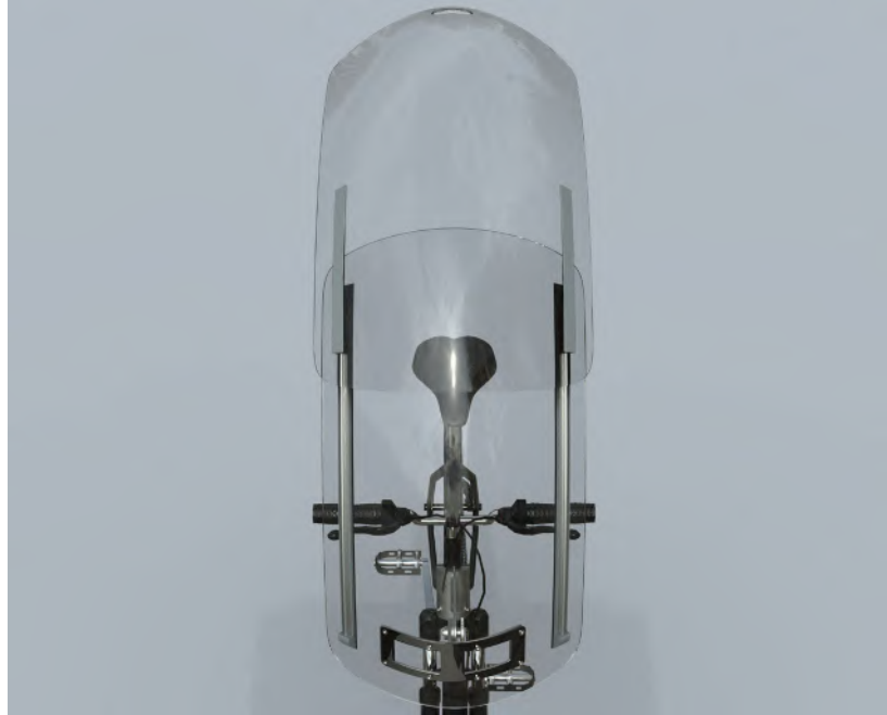
fig. 45 - Vista de topo da proposta, pormenor viseira.
