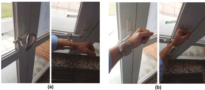
Figura 17 Testes com dispositivo dinâmico: (a) - Sistema preso no puxador existente e posição da mão para abertura; (b) - Sequência de abertura realizada por um voluntário.
