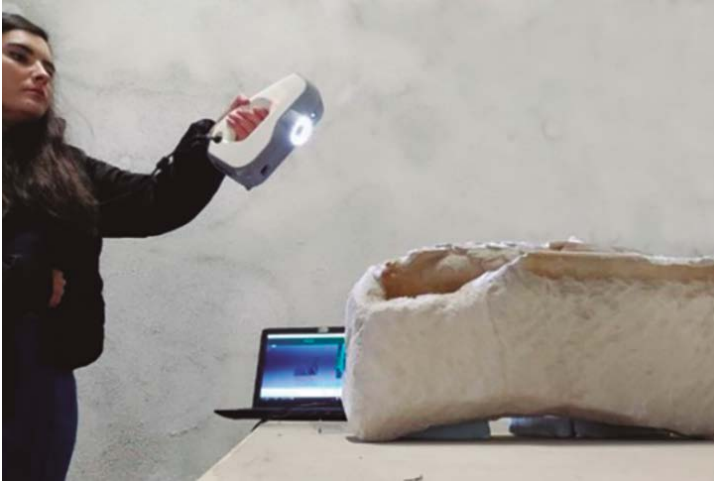
Figura 4 Processo de aquisição de imagens com o scanner 3D do serafim, 2023 Autoria: Sofia Santos.
