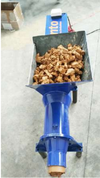
Figura 95 - Extrusora de argila
