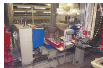
Figura 94 - Conformação de uma sanita através do enchimento sob pressão
