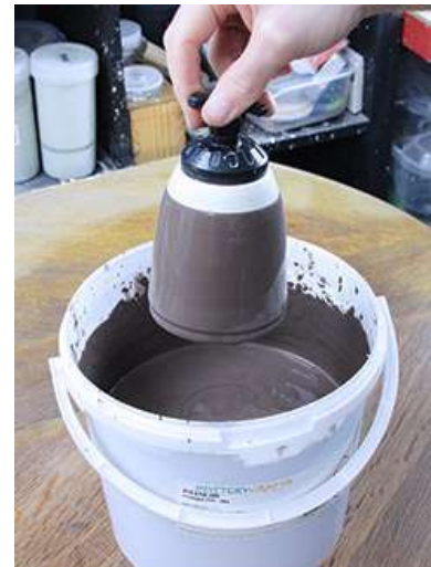
Figura 102 - Vidragem por imersão
