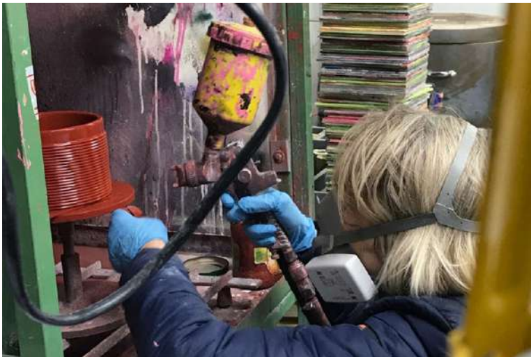
Figura 101 - Vidragem à pistola
