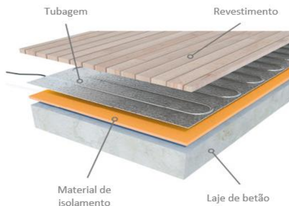
Figura 2.3 - Pavimento radiante em construção seca. Adaptado: [16]
