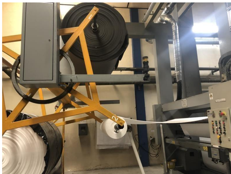
Figura 12- Alimentação de espuma
