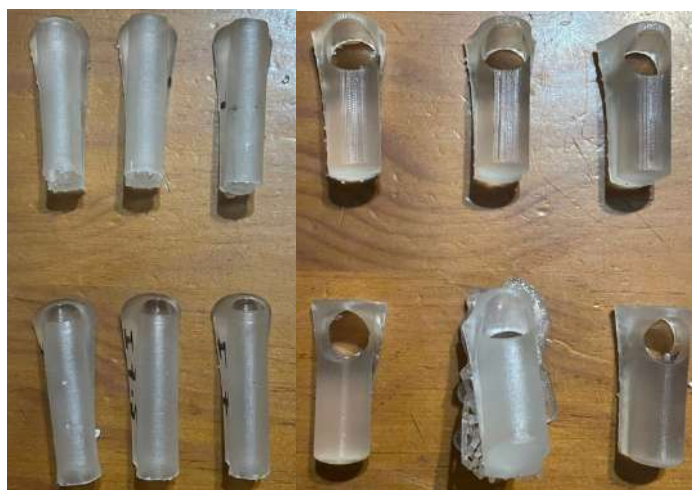
Figura 65 - Peças impressas em SLA.
