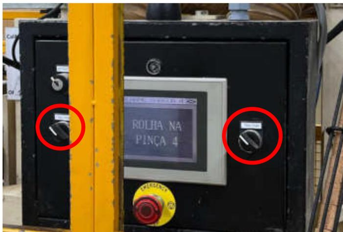
**Figura 22 - Seletores com duas velocidades**
