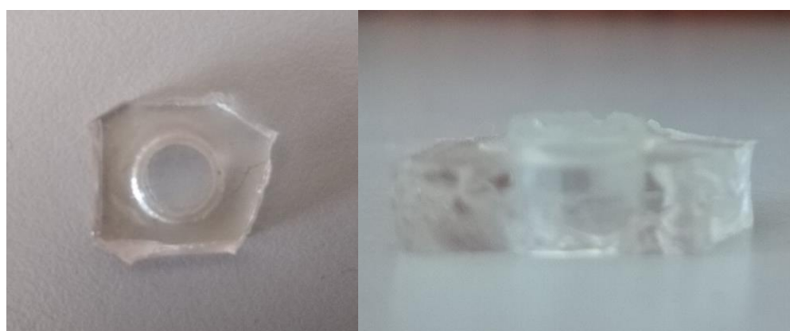
Figura 31: Estrutura auxiliar para a construção do cilindro de hidrogel
