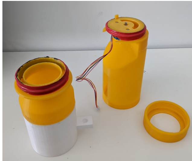
Figura 5.1: Peças produzidas em 3D. No corpo exterior observa-se já o motor 28BYJ-48 montado.
