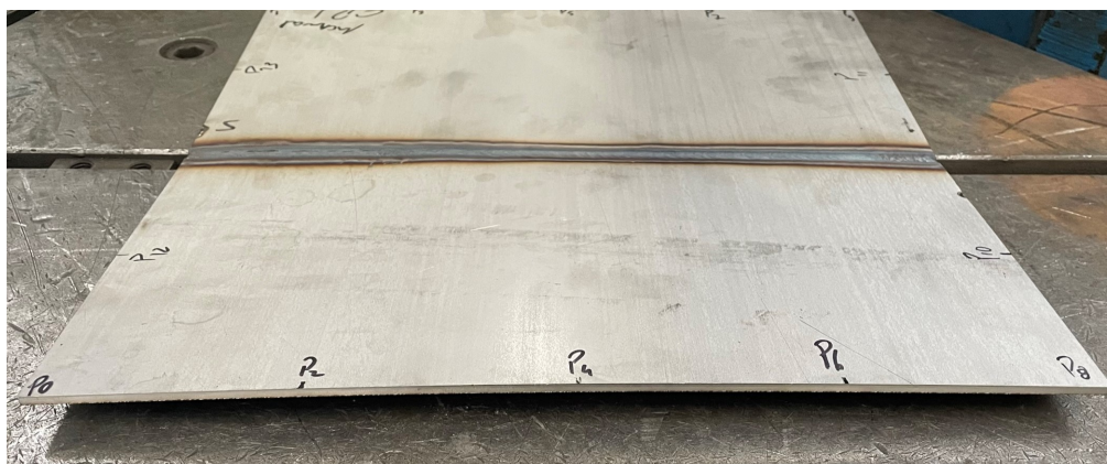
Figura 3.29: Provete após soldadura manual com deformação visível na análise 6.
