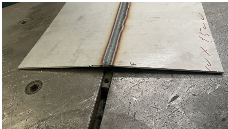
Figura 3.25: Provete após soldadura manual com deformação visível.
