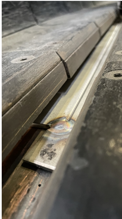
Figura 3.21: Provete antes de soldadura com calcador levantado.
