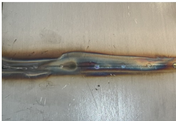
Figura 3.30: Penetração do cordão de soldadura TIG manual, análise 6.
