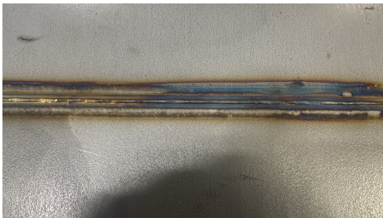
Figura 3.11: Penetração do cordão de soldadura ARCTIG, análise 1.
