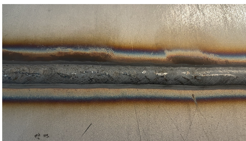
Figura 3.27: Sobre-espessura de soldadura, análise 5.
