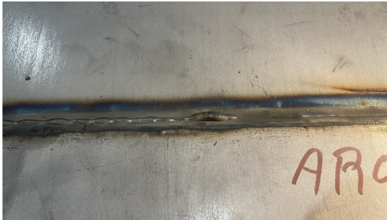
Figura 3.22: Penetração do cordão de soldadura TIG automático, análise 4.
