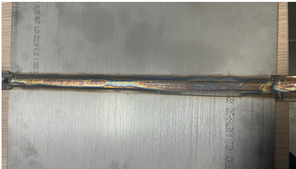
Figura 3.10: Provete válido - soldadura contínua com penetração total.
