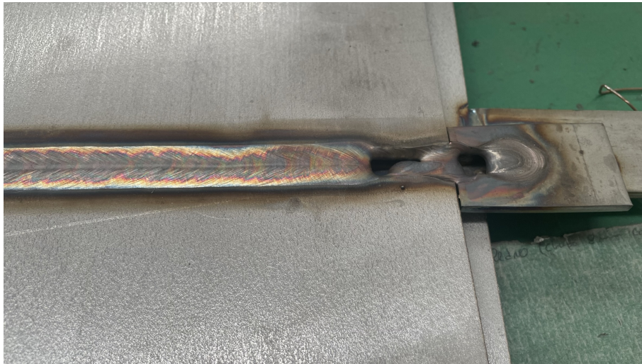
Figura 3.9: Provete inválido - descontinuidade na soldadura.
