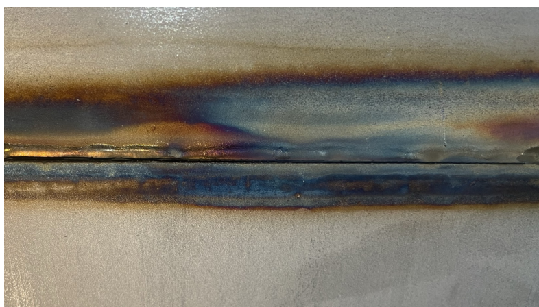
Figura 3.20: Penetração do cordão se soldadura TIG automático, análise 3.
