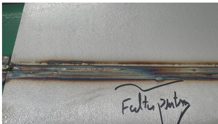
Figura 3.7: Provete inválido - falta de penetração de soldadura.
