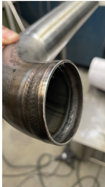
Figura 2.4: Processo de soldadura TIG, numa tubagem para a indústria alimentar.
