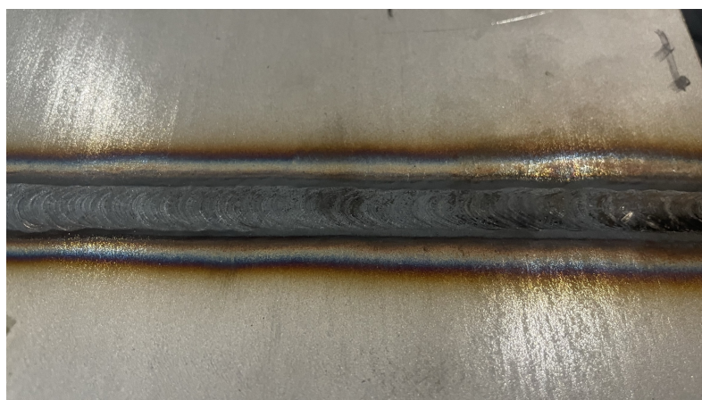
Figura 3.31: Sobre-espessura de soldadura. análise 6.
