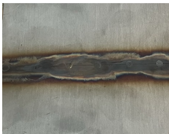
Figura 3.26: Penetração do cordão se soldadura TIG manual, análise 5.
