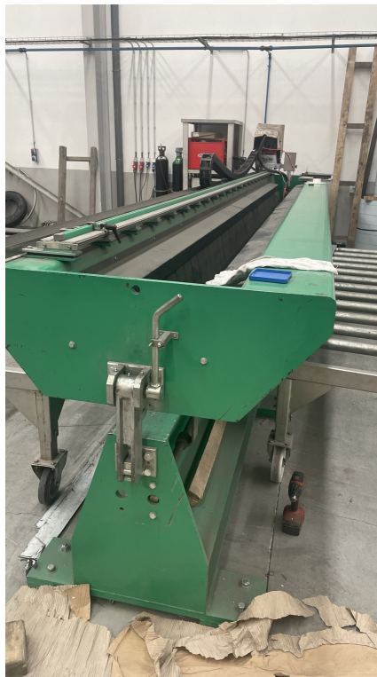
Figura 3.4: Banco de soldadura ARCTIG.
