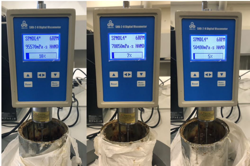
Figura 2.3: Viscosidade do produto Flexpur 280A: à esquerda à temperatura ambiente; ao centro a 50°C; à direita a 80°C.
