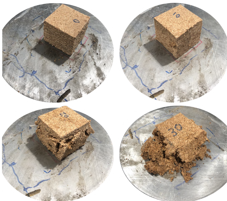
Figura 4.3: Amostras após testes de impacto com a respetiva indicação de percentagem de STF.
