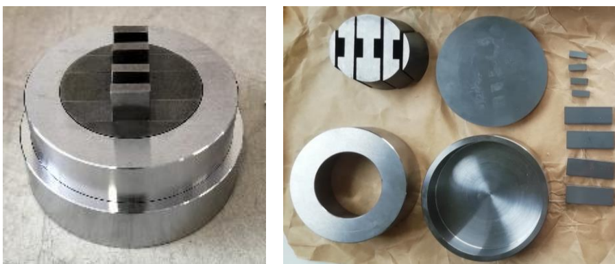
Ilustração 7 – Molde utilizado para conformação das barras.
