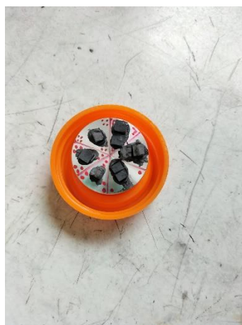
Ilustração 8 – Amostras (fraturas) preparadas para MEV.
