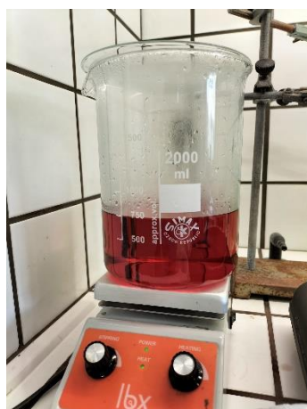
Ilustração 5 Solução do nitrato de cobalto com o nitrato de cálcio em agitação lenta e temperatura de cerca de 150 °C.
