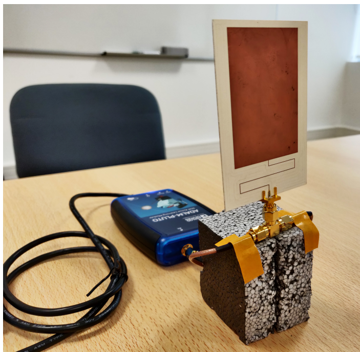
Figura 5.4: SDR ADALM-PLUTO acoplado a uma das antenas desenvolvidas.
