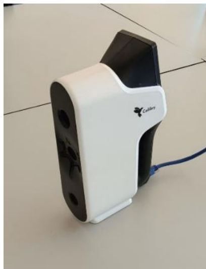
Figura 28. Scanner de luz estruturada utilizado (Calibry 3D Scanner)
