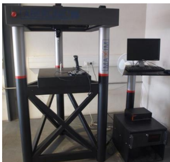
Figura 29. Máquina de medição por coordenadas utilizada (Maxim, Aberlink)
