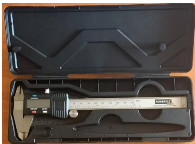
Figura 27. Paquímetro digital utilizado (Powerfix, Profi)
