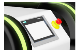
Figura 78 - Ecrã LCD a 45° e botão de emergência.
