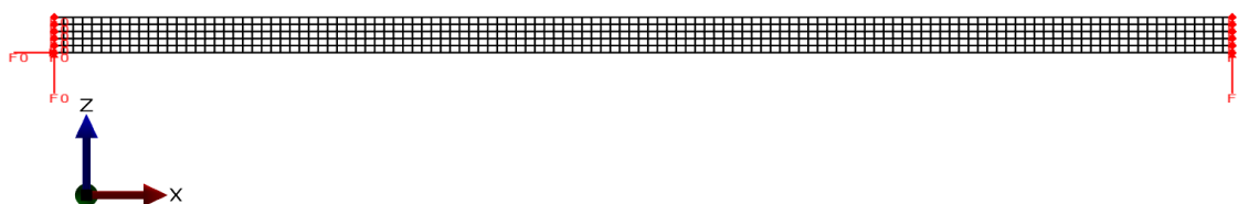
Figura 40 - Malha 30x40 mm usada na secção transversal 150x20 mm.
