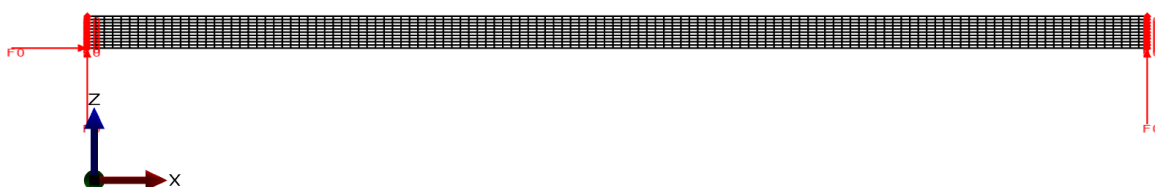
Figura 39 - Malha 15x40 mm usada na secção transversal 150x20 mm.
