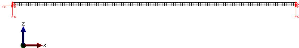
Figura 41 - Malha 30x40 mm usada na secção transversal 60x40 mm.
