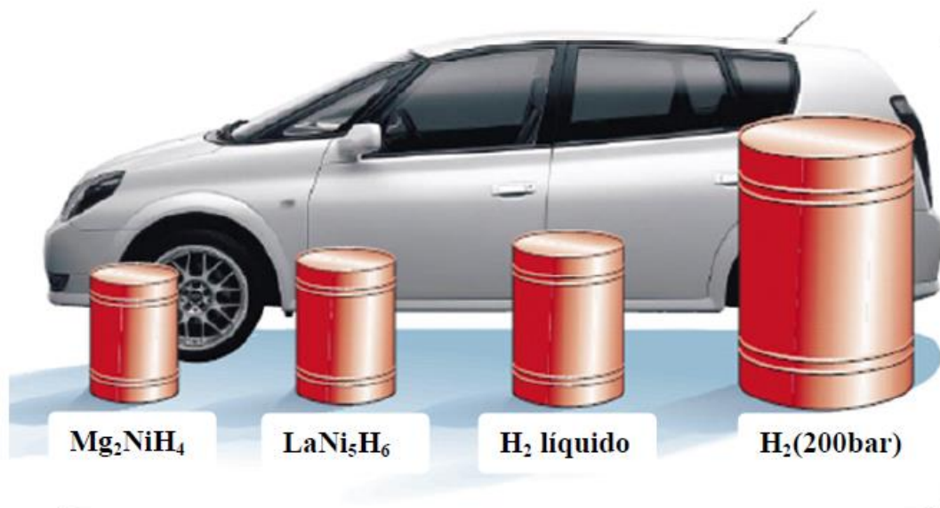
Figura 7- Ilustração do volume ocupado por 4 Kg de hidrogénio armazenado no estado gasoso em hidretos metálicos, estado líquido (-253°C) e estado gasoso pressurizado a 200 bar [21].
