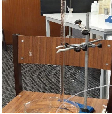
Figura 56- Dispositivo utilizado para medir o volume no segundo método
