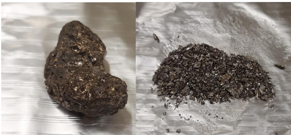
Figura 61- LaNi 5 em estado bruto (esquerda) e dividido em pedaços mais pequenos (direita)
