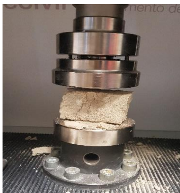
Figura 27 - Ensaio de compressão de um dos provetes de adobe
