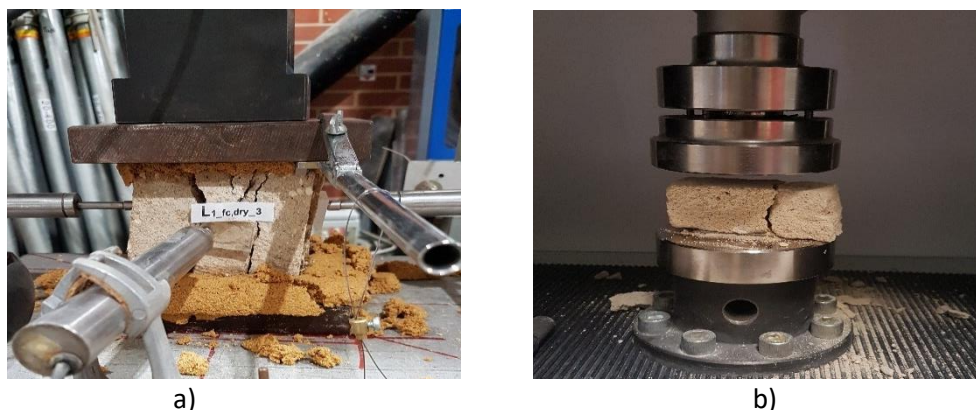
Figura 20 - a) Ensaio de compressão de provete L1_fc_dry_3, b) Ensaio de compressão com dimensão 16 x 4 x 4 cm 3
