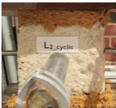
Figura 21 - Ensaio de compressão de provete L2_cyclic
