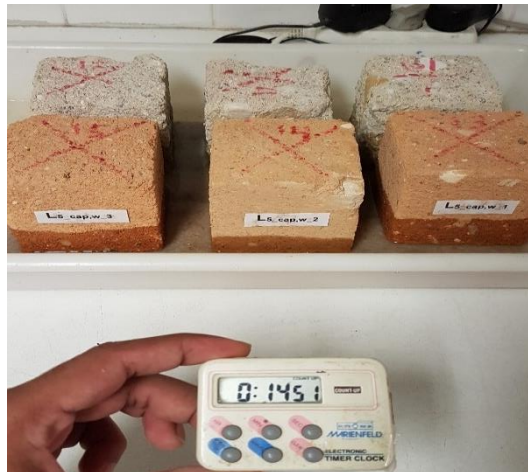
Figura 18 - Ensaio de absorção por capilaridade a decorrer dentro de um tabuleiro plástico e com um temporizador.
