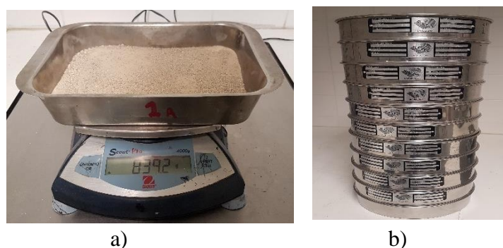
Figura 23 - Procedimento para a caracterização da granulometria: a) determina de adobe, b) peneiração (ASTM)
