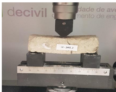
Figura 25 - Ensaio de flexão do provete L2_fxk_2
