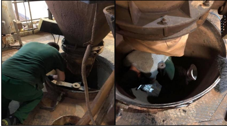
Figura 28 - Fotos da limpeza do misturador (processo não ergonómico)
