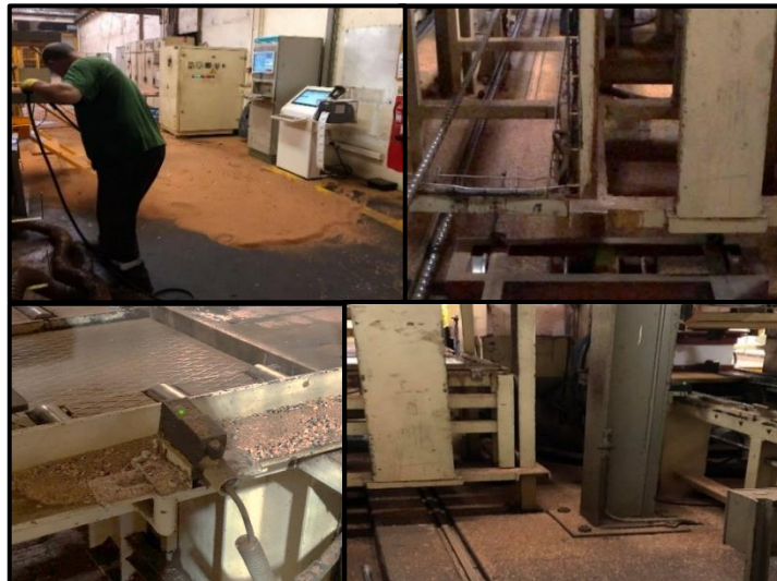
Figura 31 - Exemplos de acumulação de granulado pelo centro de trabalho
