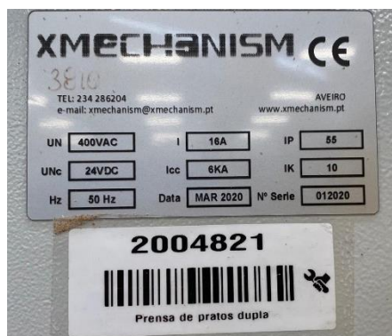
Figura 29 - Etiqueta identificadora dos equipamentos
