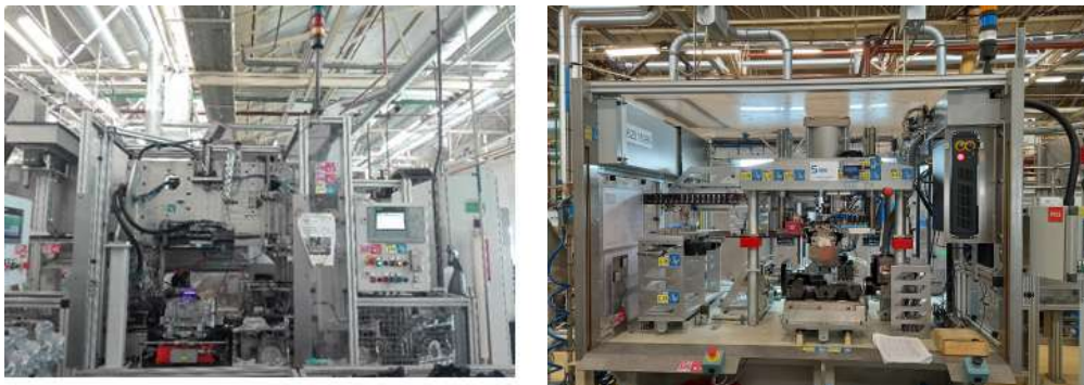
Figura 4.9: Linha nº3: à esquerda a máquina de montagem e à direita a máquina de estanqueidade.
