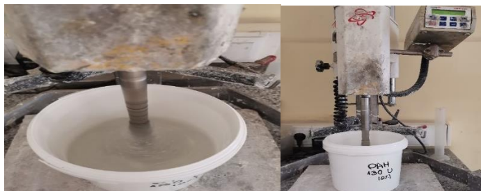
Figura B.1-Preparação das soluções com o auxílio da misturadora da marca Raybery TURBOTEST 230V50Hz do tipo 331300
