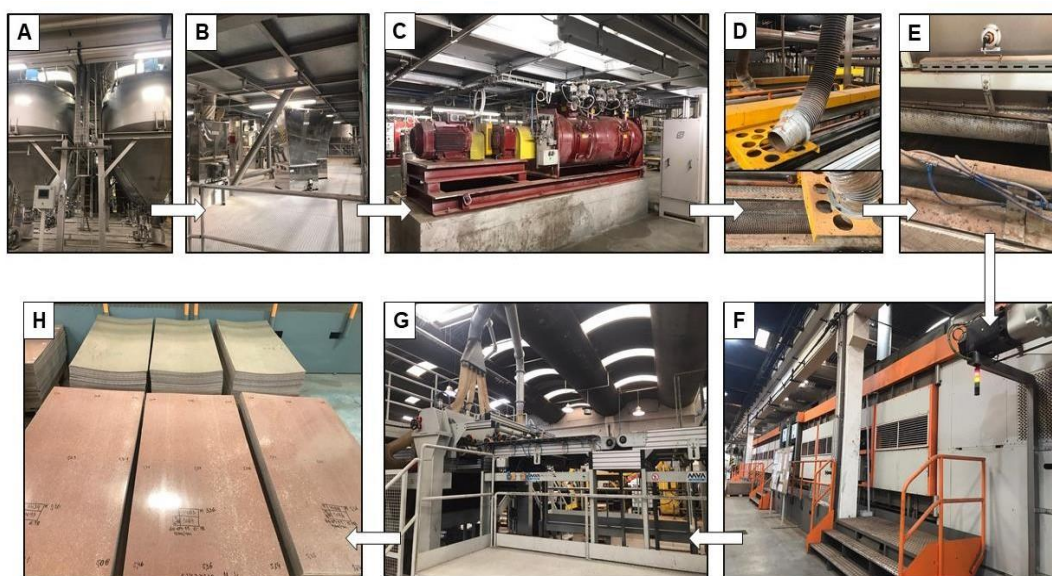
Figura 3 - Etapas do processo de fabrico do core: A) armazenamento das matérias-primas nos respetivos silos; B) doseamento de cada matéria-prima; C) mistura no "Dry Blender"; D) distribuição da mistura; E) distribuição da mistura na tela andante a partir da queda do rolo de picos; F) prensagem; G) corte do core em três partes; H) core cortado em três partes, que seguirão para a etapa de polimento.
