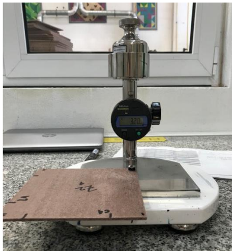
Figura 25 - Equipamento utilizado para medição da espessura em cada aresta da placa.
