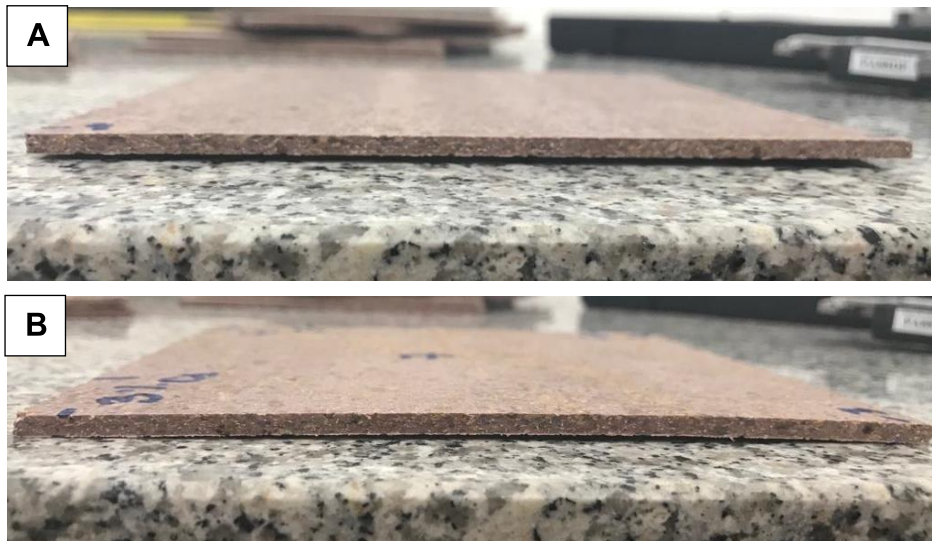
Figura 23 - Representação do sentido do encurvamento: A) negativo; B) positivo.
