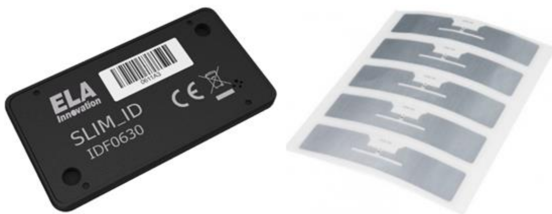
Figura 20 - Etiqueta RFID ativa e passiva
