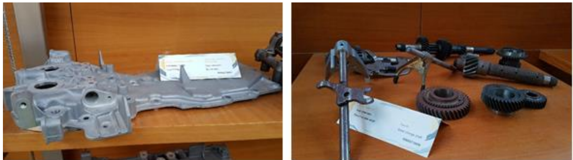
Figura 14 - Carter distribuição e apoio da cambota - Eixo m/ atrás e eixo fixo
