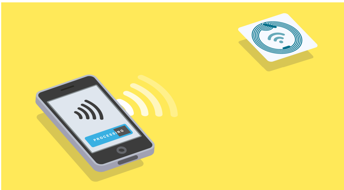
Figura 6 - Exemplo do modo de operação de Leitura e gravação entre um smartphone e uma tag NFC
