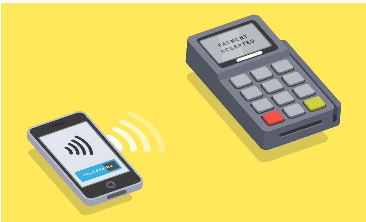
Figura 8 - Exemplo do modo de operação "Emulação de cartão" entre um smartphone e um terminal de pagamento
