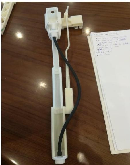
*Figura 58- Protótipo de sensor de nível.*
