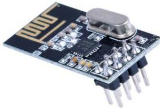
*Figura 44-Placa de comunicação NRF24L01.*
