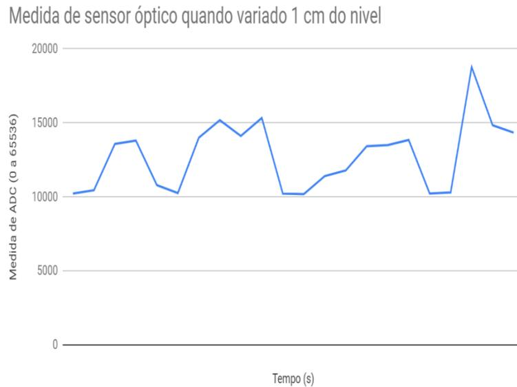
Figura 38- Resultados do sensor ótico quando variado 1cm do nível com ADC de 16 Bits.
