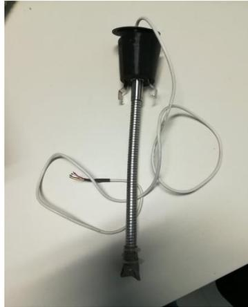
Figura 29- Sensor capacitivo
