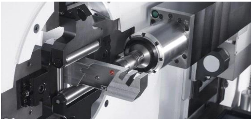
Figura 3.2- Corte de Geometrias especiais. Fonte: TRUMPF.
