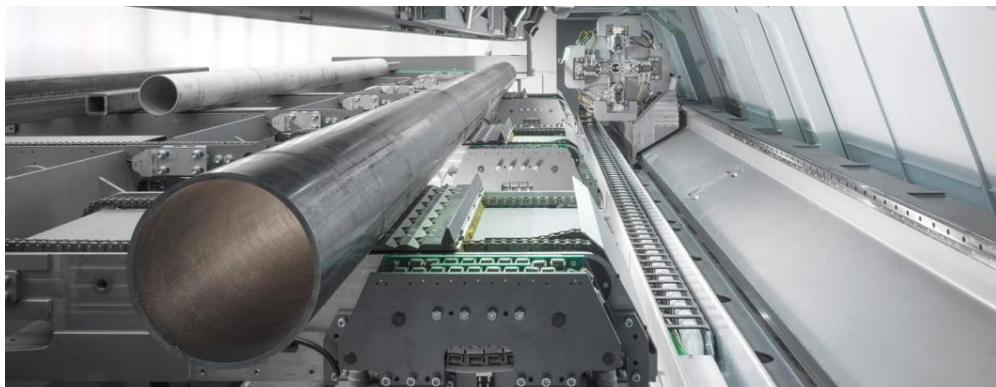
Figura 3.9- Exemplificação do modo de Carga da peça em bruto. Fonte: BLM Group.
