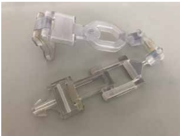
Figura 2.10 Conjunto de peças articuladas impressas numa única operação por MJ
