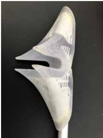
Figura 8.28 Peça impressa em 3D pelo processo MJ
