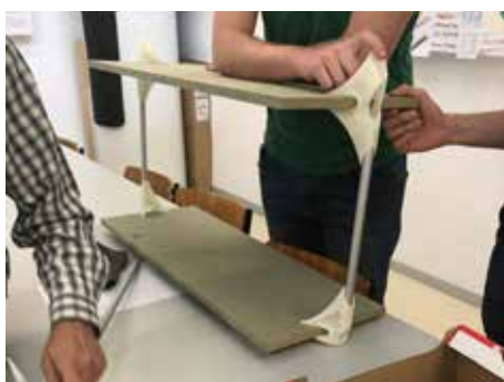
Figura 8.26 Configuração de estante do projeto da Linha de Mobiliário desmontável
