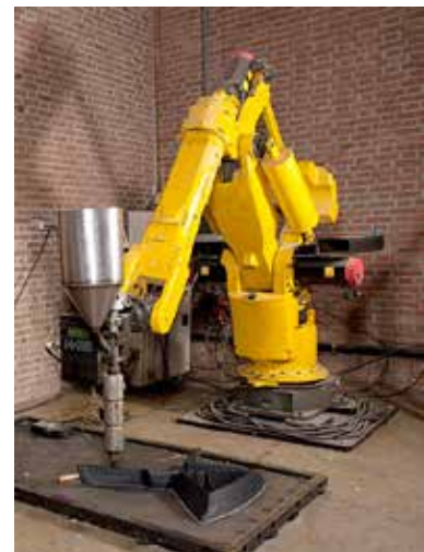
Figura 7.12 Impressão da cadeira através de braço robotizado ( https://coolhunting.com/design/dirk/ )
