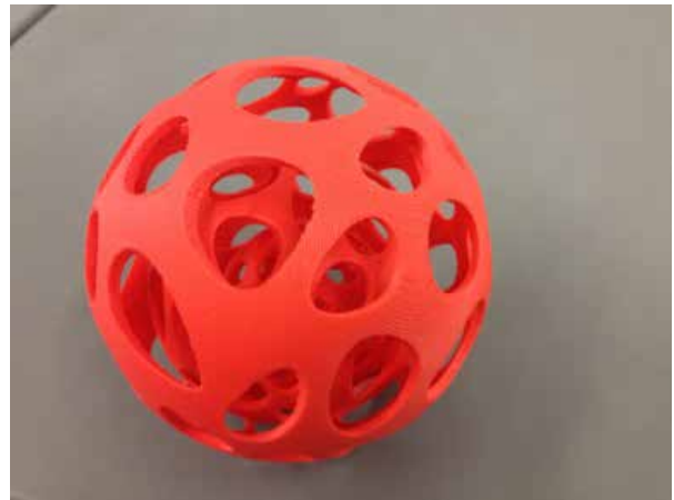
Figura 2.4 Objeto com insertos, produzidos numa única operação em FFF
