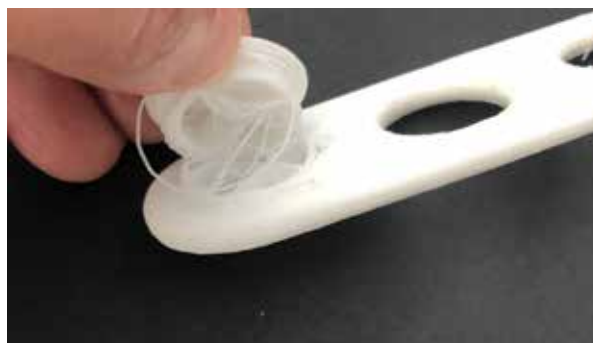
Figura 8.36 Problemas na impressão devido à anisotropia do processo FFF
