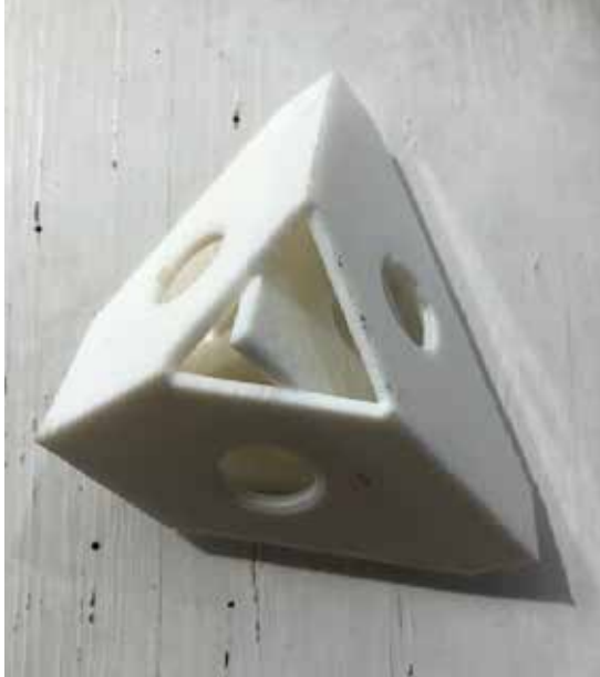
Figura 7.32 Peça do Sistema Modular Organizacional Expositivo impressa em FFF
