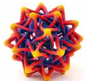
Figura 2.13 Peça multicolorida impressa em binder jetting ( http://moleculadigital.eu/markets/3d-printing/material-jetting.html )
