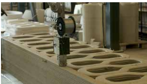
Figura 3.13 Teste à distribuição do material (cimento) no interior das paredes
