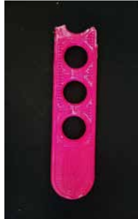
Figura 8.34 Protótipo para testar as dimensões dos furos
