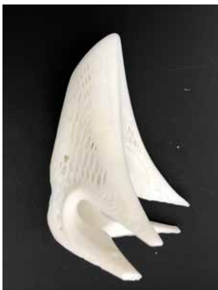
Figura 8.24 Protótipos em ABS impresso por FFF na impressora Dimension
