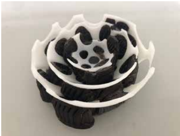
Figura 2.3 Material de suporte solúvel que permite imprimir numa única operação esferas dentro de esferas
