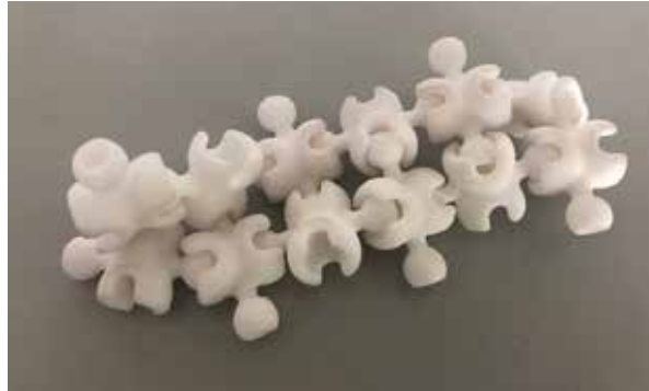
Figura 2.8 Objeto com múltiplas peças ( multi-assemblies ) impresso numa única operação por SLS
