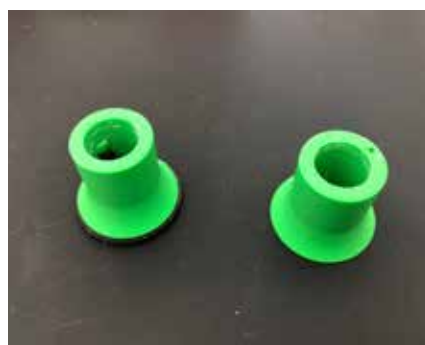
Figura 8.27 Objetos intermédios de teste para acertar as medidas dos tubos de metal
