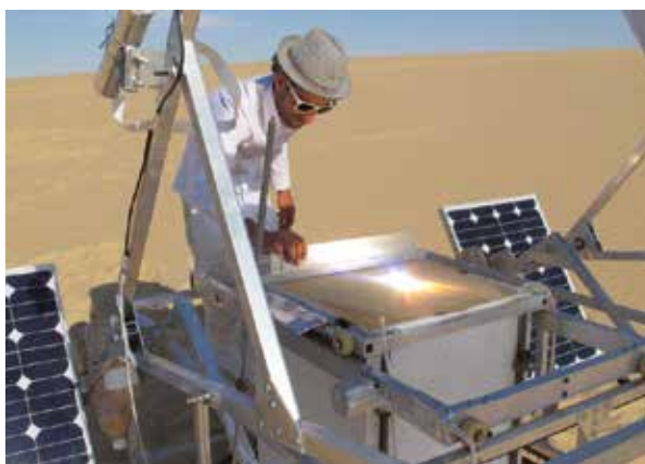
Figura 3.9 No deserto, a impressora 3D de Michael Kaiser a imprimir peças a partir da matéria prima local, a areia, e da fonte de energia abundante, a luz solar (Kaiser, 2011)
