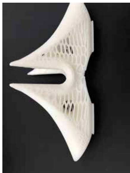
Figura 8.25 Protótipos em ABS impresso por FFF na impressora Dimension
