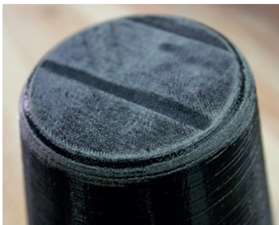
Figura 69 - Pormenor do resultado da abrasão da superfície do contra molde em PLA, ainda sem acabamento e correspondente ao vaso interior.
