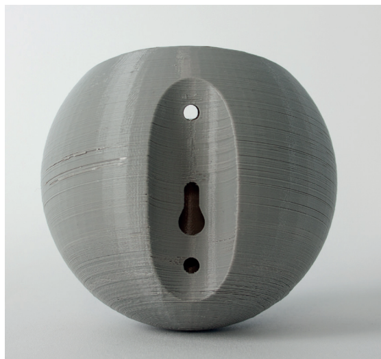
Figura 65 - Pormenor da região de contacto com a haste do primeiro protótipo realizado em PLA, correspondente ao modelo completo do vaso.
