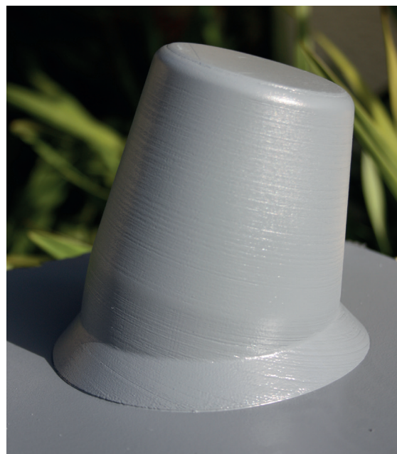
Figura 70 - Pormenor da primeira camada de tinta aplicada no contra molde relativo ao vaso interior.
